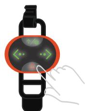
4. Die LEDs der Fernbedienung und des Panels leuchten bei erfolgreicher Kopplung auf.
