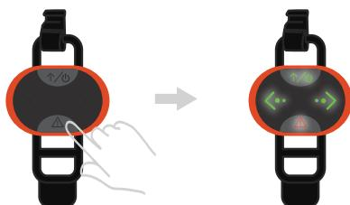
3. Drücken Sie die "!"-Taste der Fernbedienung, um die Kopplung zu bestätigen.
