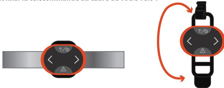
Fixez la télécommande en enroulant l'attache caoutchouc autour de la barre du guidon.
