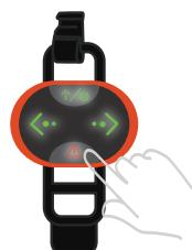
4. Les LED de la télécommande et du panneau indicateur vont alors s'allumer si l'accouplage est réussi.
